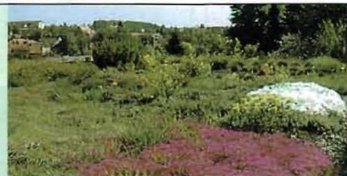
Una terrazza architettonica, estetica, versatile, rappresentativa (peso 250 kg/mq) con piante erbacee perenni e cespugli senza particolari esigenze di manutenzione.
