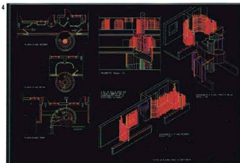
4. Progetto di una inferriata di divisione per ballatoio. Arch. Aurelia D'Andria. In questo esempio si può notare che Point Line non ha problemi ad impaginare disegni in scala differente e disegni tridimensionali nella medesima tavola dopo l'eliminazione delle linee nascoste.
